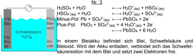
Das Bleioxid verbindet sich mit einem weiteren Schwefelsäurerestion und 4  $H_3O^+$ -Ionen und nimmt zwei Elektronen auf. Dadurch entsteht eine Spannung, die abgegriffen werden kann. Legt man an den Akku eine Spannung an, die größer ist als diejenige, welche angegriffen werden kann, kehrt sich die chemische Reaktion um und der Akku wird aufgeladen.
